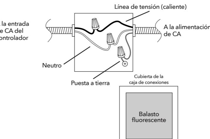
**IMPORTANTE:** El balasto fluorescente debe permanecer conectado a la cubierta de la caja de conexiones.
